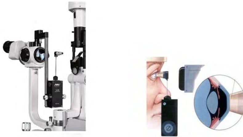
Figura 23. A la izquierda: tonómetro de Goldmann. A la derecha: contacto de pequeño cono con la córnea del paciente.
